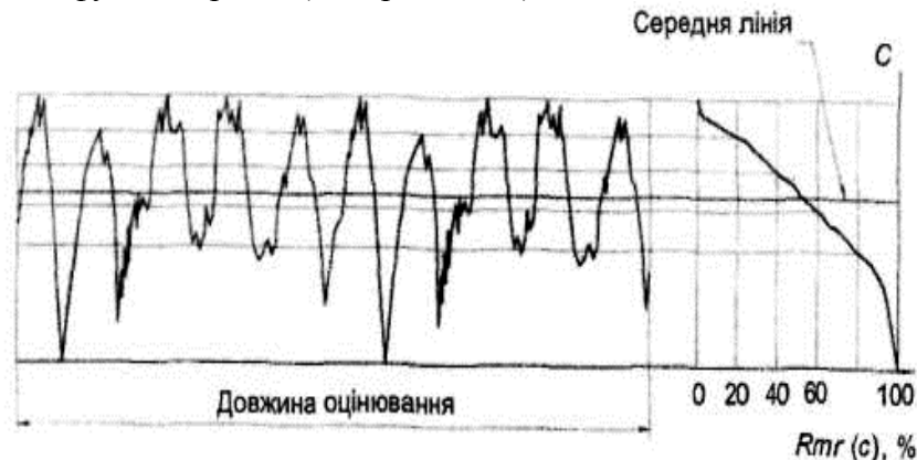
Рис. 4.11. Відносна опорна крива [ДСТУ ISO 4287 рис.11, с.3]
