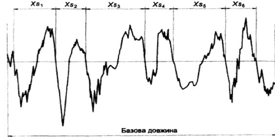
Рис. 4.10. Ширина елементів профілю [ДСТУ ISO 4287 рис.10, с.3]
