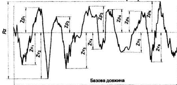
Рис. 4.7. Максимальна глибина западини профілю (приклад шорсткості профілю) [ДСТУ ISO 4287 рис. 7, с.7]
