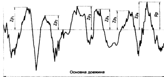
Рис. 4.6. Максимальна висота виступу профілю (приклад шорсткості профілю) [ДСТУ ISO 4287 рис. 6, с.6]
