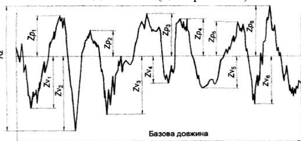
Рис. 4.8. Максимальна висота профілю (приклад шорсткості профілю) [ДСТУ ISO 4287 рис. 8, с.7]
