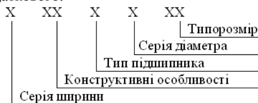
Схема основного умовного позначення підшипника кочення
